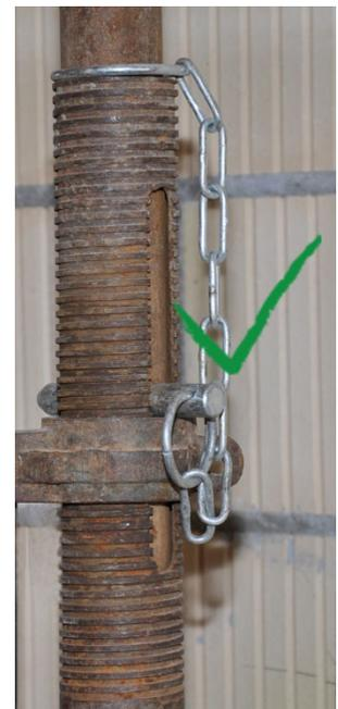
4 Geeigneter Steckbolzen, gegen Verlust gesichert
